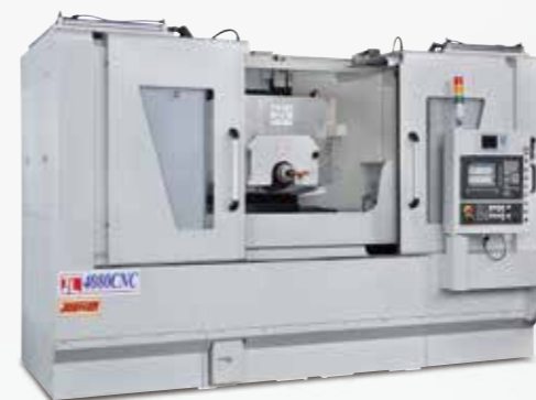
▲ JL-4080CNC-344 同時研磨滑塊兩個研磨面(滑塊的直角)
